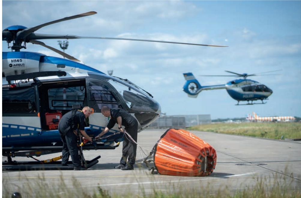
Mit Hilfe eines Lasthakens und eines „Stoßdämpfers“ in Form eines Seils wird der Löschwasserbehälter, der leer bereits knapp 50 Kilogramm wiegt, am Hubschrauber befestigt.
