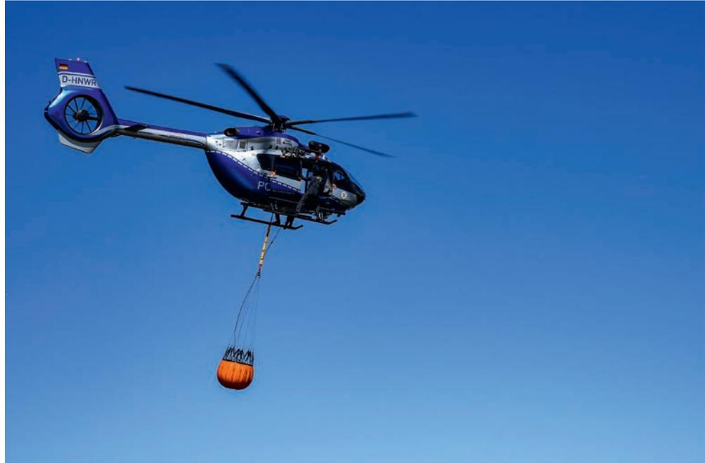
Es erfordert einiges an fliegerischem Können von den Piloten, da ein in der Luft schwankender Behälter den Heli gehörig aus der Balance bringen kann.
