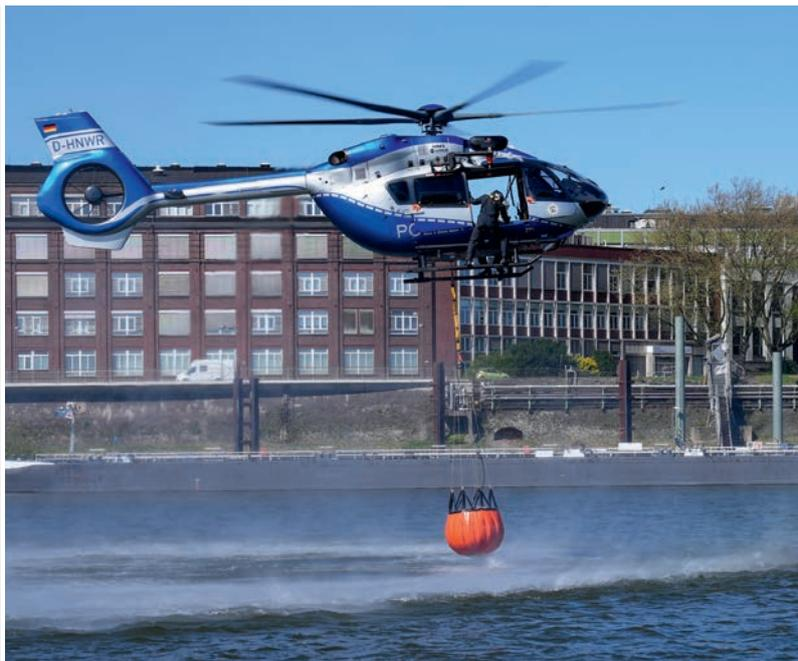
Nach der Wasseraufnahme hängen plötzlich 800 Kilo Gewicht an dem Hubschrauber. Auf diese Zusatzbelastung müssen sich die beiden Piloten vorher genau einstellen.
