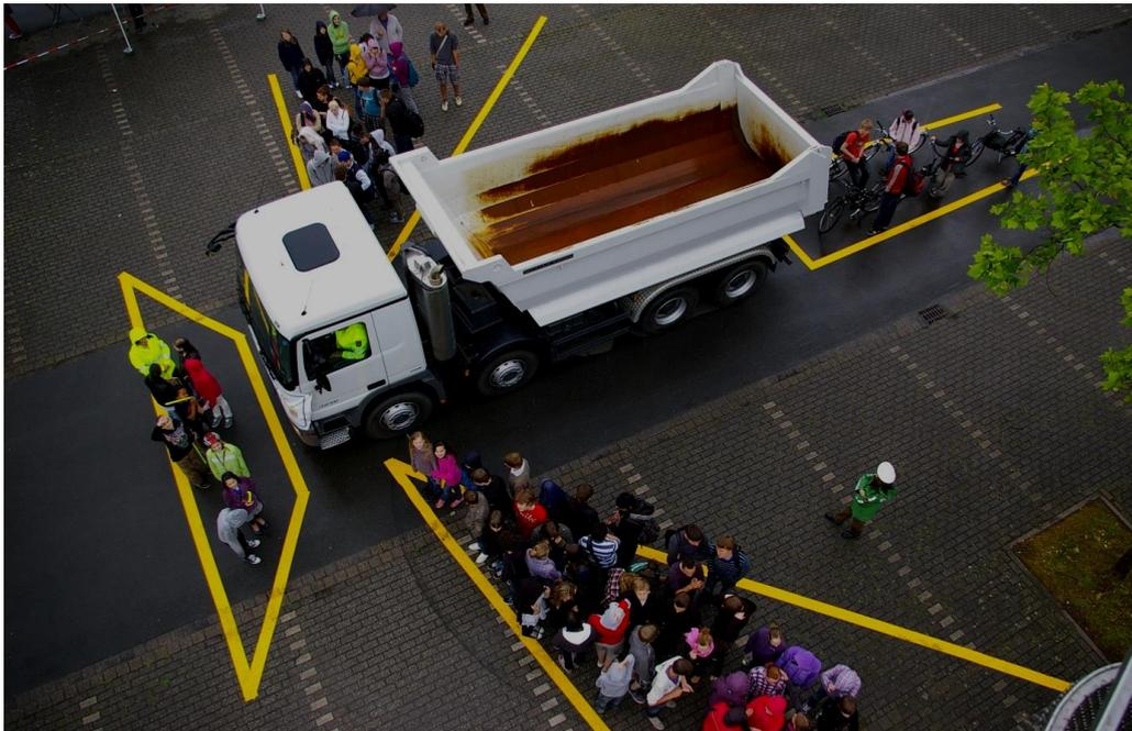
Die toten Winkel bei einem Lkw liegen seitwärts neben dem Fahrzeug, aber natürlich auch unmittelbar vor der Frontscheibe und im rückwärtigen Bereich. Die größten Gefahren ergeben sich daher beim Abbiegen oder Fahrstreifenwechsel (seitlicher toter Winkel), beim Anfahren (vorderer toter Winkel) und beim Rangieren (vorderer und hinterer toter Winkel).
