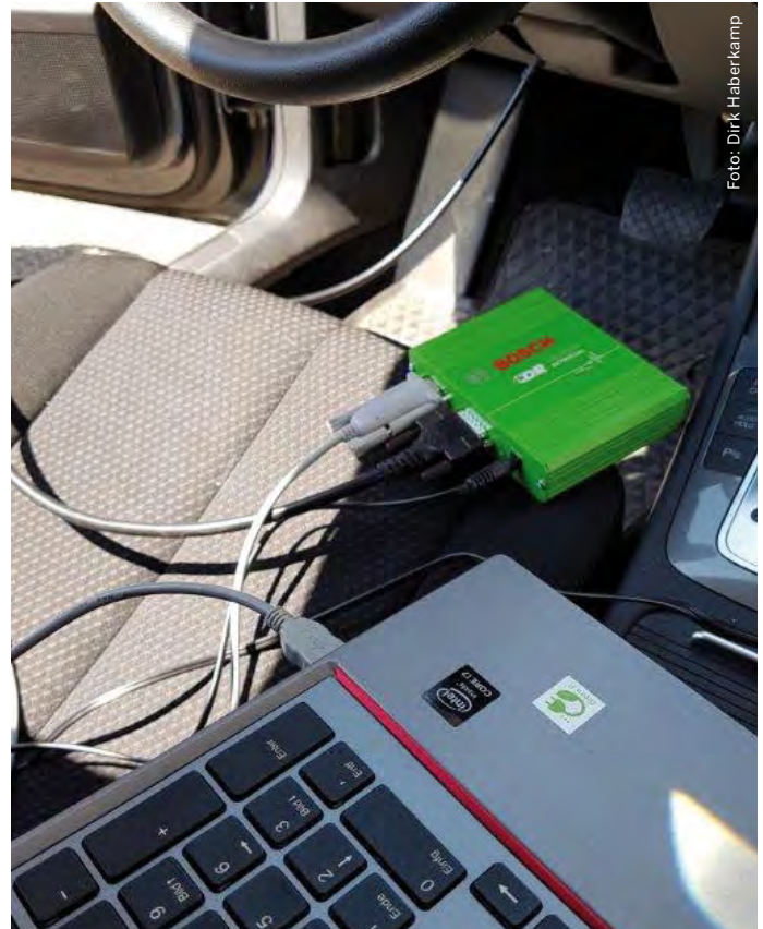
Durch das Auslesen der Daten mit einem CDR-Gerät lassen sich wichtige Beweise sichern.
